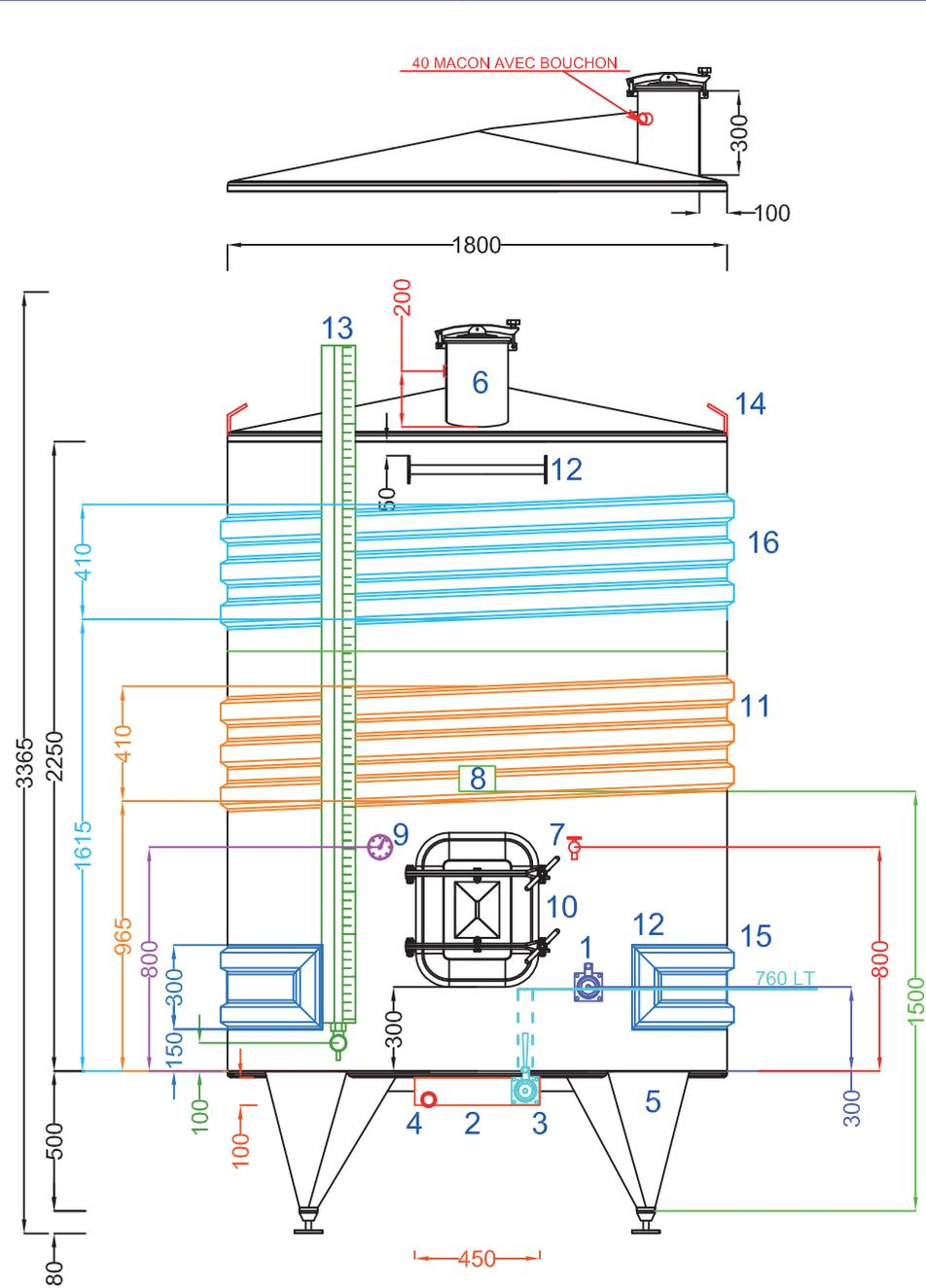
SURFACE D'ECHANGE TOT 5,51 MQ POIDS CUVE 455 KG
